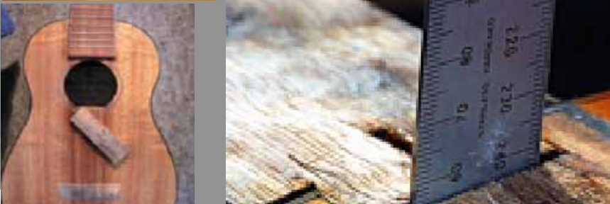
ジョイント部分に隙間がある為ネックが反ってしまったケース
